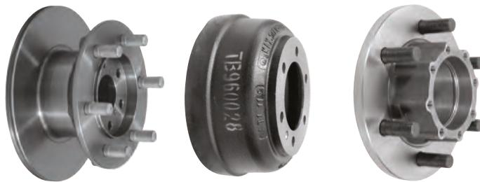
DISCHI FRENO | TAMBURI FRENO | MOZZI RUOTA
